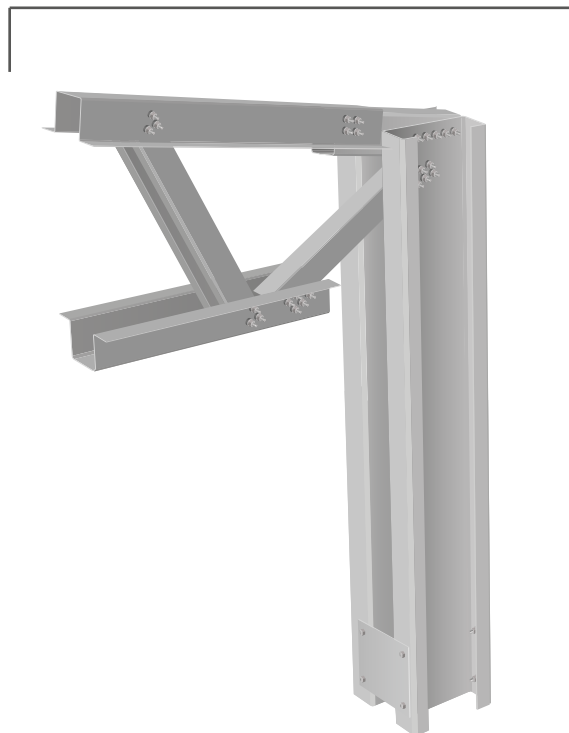
POŁĄCZENIE PRZEGUBOWE NA SŁUPIE STALOWYM
