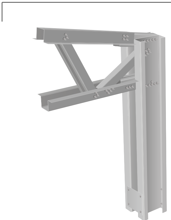
POŁĄCZENIE SZTYWNE NA SŁUPIE STALOWYM
